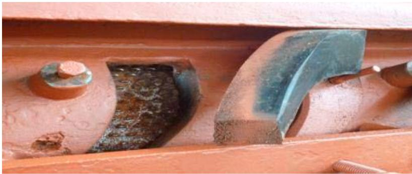
Figura 3.10.4 - Detalhes das borrachas no descascador
