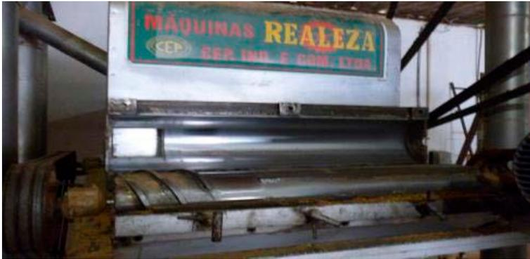
Figura 3.10.7 - Detalhe do descascador de rolo
