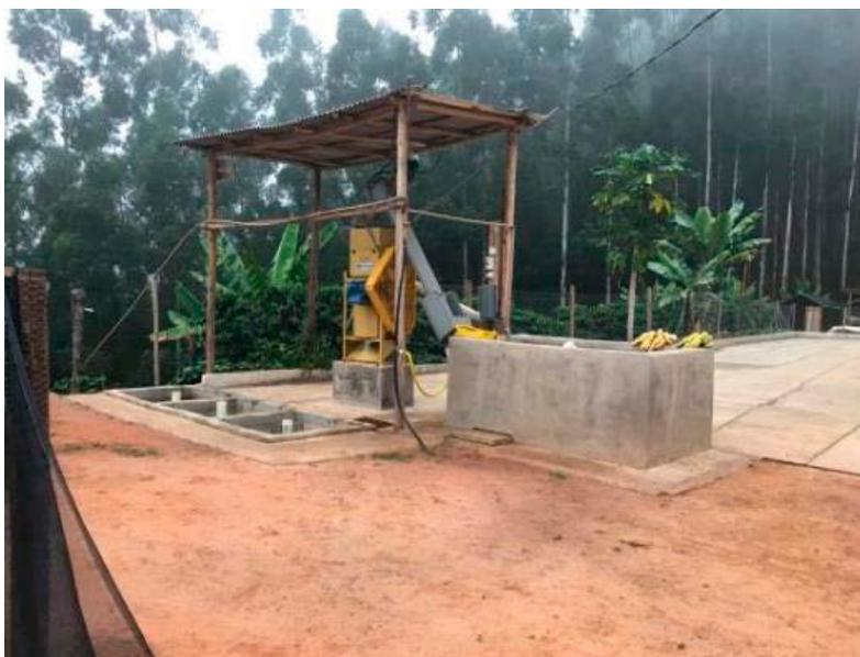
Figura 3.8.2: Unidade de Processamento, composta de taque lavador, descascador/separador e SLAP. Sítio Conquista.
