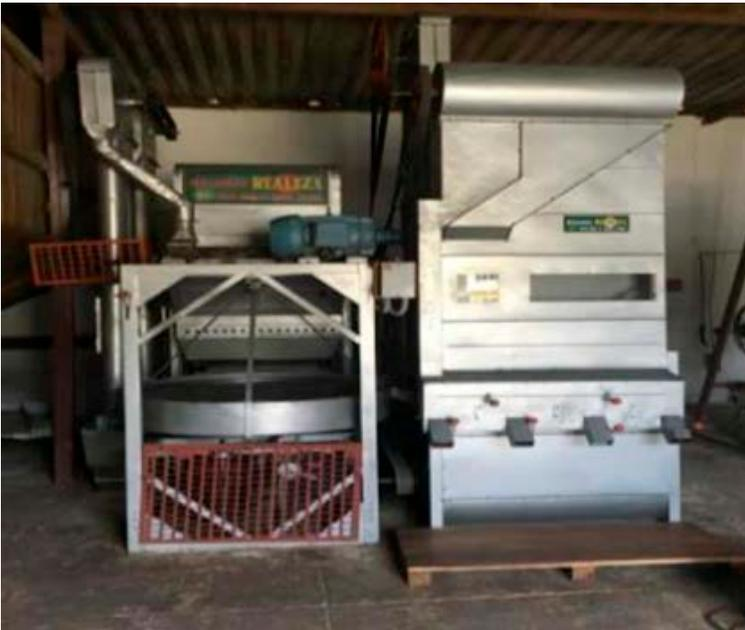
Figura 3.10.6 – Rolo Descascador via seca e coluna de classificação
