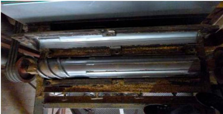
Figura 3.10.8 - Vista de cima do descascado de rolo (Tampa aberta)
