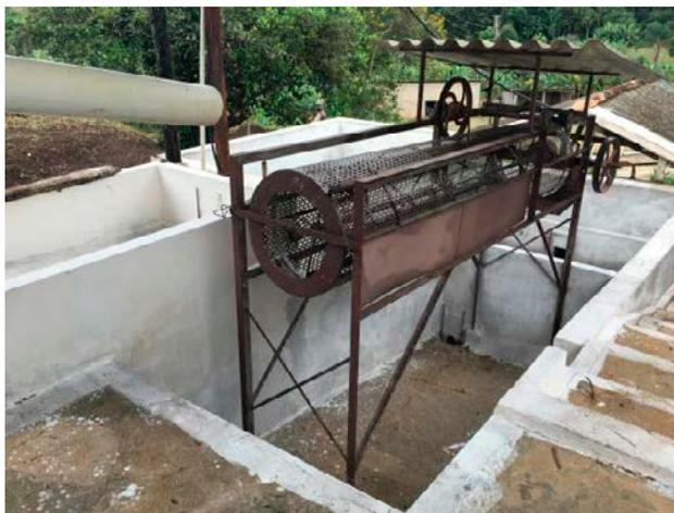
Figura 3.10.2 – Cilindro para separação do boia passa
