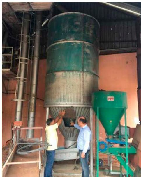
Figura 3.10.12 - Secador vertical
